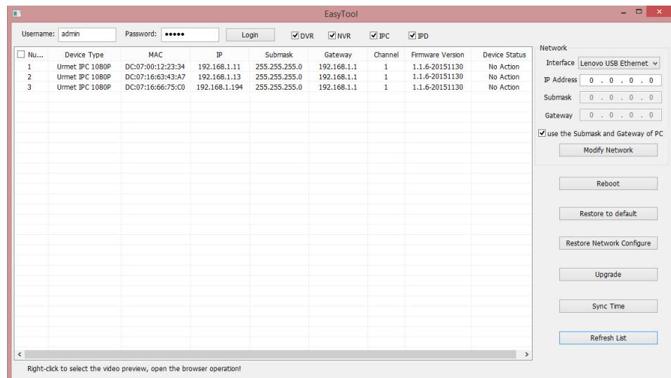
Befinden sich die gesuchte IP-Adresse und die IP-Adresse des PC nicht in demselben Netz, kann der Benutzer die IP-Adresse, die Subnet Mask und andere Parameter der IP-Kamer unter Einsatz der Software Easy Tool ändern.
