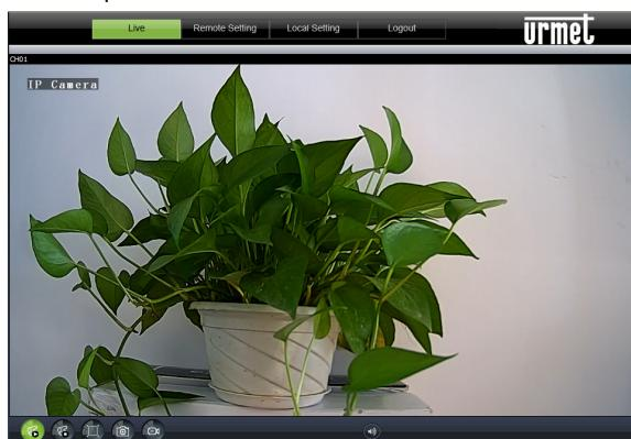
6. Appuyer sur la touche droite de la souris pour sélectionner le flux vidéo (Main Stream, Sub Stream ou Mobile Stream) et afficher le débit en bits (bitrate).
