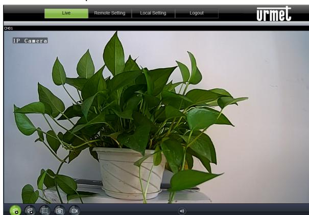
6. Premere il pulsante destro del mouse per selezionare il flusso video (Main Stream, Sub Stream o Mobile Stream) e per visualizzare il bitrate.
