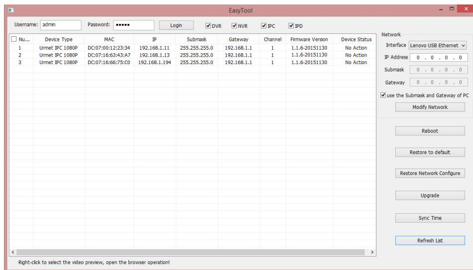
Si l'adresse IP recherchée et l'adresse du PC ne se trouvent pas sur le même réseau, l'utilisateur peut modifier l'adresse IP, le masque de sous-réseau et d'autres paramètres de la caméra IP, en utilisant le logiciel Easy Tool.
