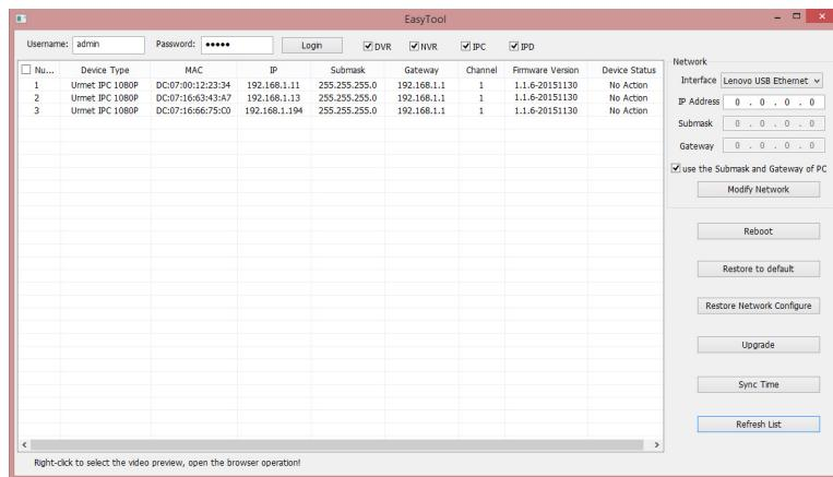
Se l'indirizzo IP cercato e l'indirizzo IP del PC non sono nello stesso rete, l'utente può modificare l'indirizzo IP, la subnet mask e altri parametri della telecamera IP utilizzando il software Easy Tool.
