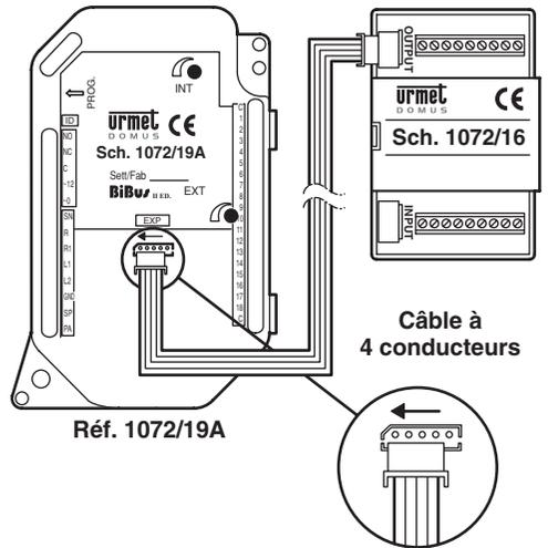
**N.B.:** Si le câble n'est pas engagé correctement, les touches associées aux modules d'expansion n'envoient pas l'appel.
