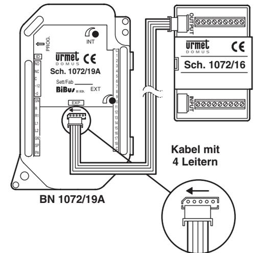
**HINWEIS:** wenn das Kabel nicht korrekt eingesteckt ist, übertragen die mit den Erweiterungsmodulen verknüpften Tasten den Anruf nicht.
