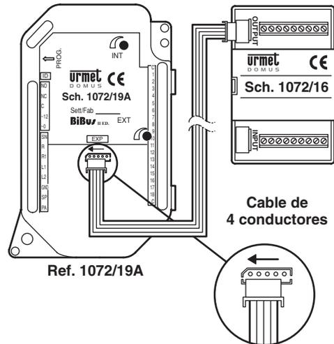
**Nota:** Si el cable no está correctamente introducido, las teclas asociadas a los módulos de expansión no envían la llamada.
