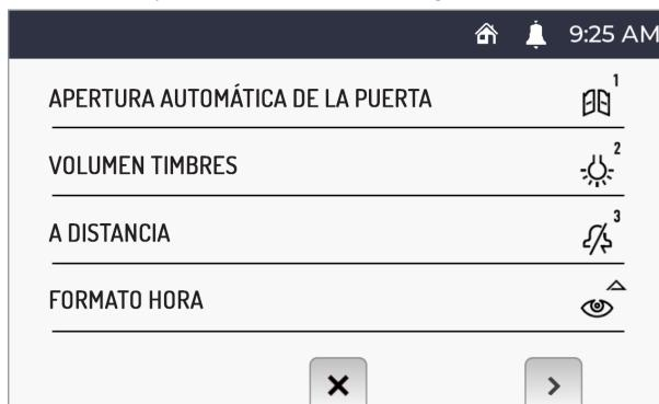
Pulsar el botón en la pantalla 1 del menú de configuración. Cada vez que se pulsa el botón, el videointerfono muestra y configura el volumen de llamada seleccionado (el volumen cambia según la secuencia: BAJO, MEDIA, ALTO).
