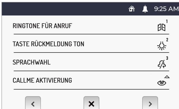
Die Taste <sup>2</sup> in der Ansicht 2 des Konfigurationsmenüs drücken, um die Lautstärke der Tasten zu sperren oder freizuschalten.
