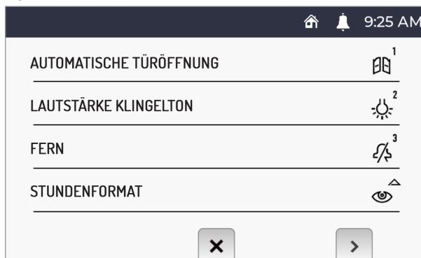
Die Taste <sup>2</sup> in der Ansicht 1 des Konfigurationsmenüs drücken. Bei jedem Tastendruck zeigt die Sprechanlage die gewählte Ruf lautstärke an und konfiguriert diese (die Lautstärke ändert sich in der Abfolge: LEISE, MITTEL, LAUT).
