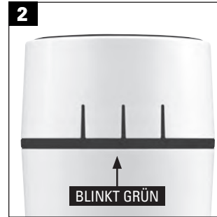
Wenn die Stummschaltung aktiv ist, blinkt der LED-Ring in regelmäßigen Abständen grün.
