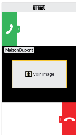
Réception Appel Intercom
