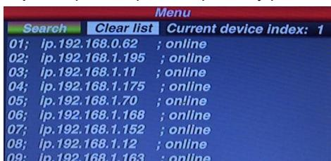
Después de la búsqueda, el usuario puede seleccionar los dispositivos moviendo el joystick y presionando el botón “**Enter**”. Luego puede almacenar el dispositivo, mostrar sus imágenes y moverlo.
