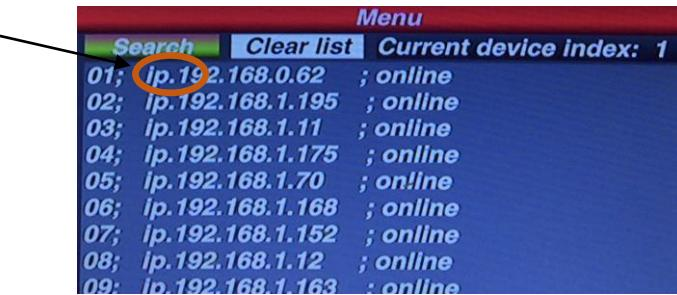
Appuyer sur la touche “**Addr**”, sélectionner le numéro d'identification correspondant de la liste et appuyer sur la touche “**Enter**” pour visualiser les images du dispositif IP.
