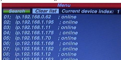
Nach abgeschlossener Suche kann der Benutzer die Geräte auswählen, indem er den Joystick bewegt und die „**Enter**“-Taste drückt. Nun kann er das Gerät speichern, dessen Bilder anzeigen und das Gerät bewegen..
