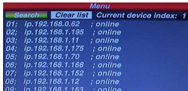
Une fois la recherche terminée, l'utilisateur peut sélectionner les dispositifs à l'aide du joystick et en appuyant sur la touche “**Enter**”. Il peut ensuite mémoriser le dispositif, en visualiser les images et l'actionner.
