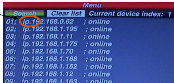
Die „**Addr**“-Taste drücken, die entsprechende Identifikationsnummer der Liste auswählen, die „**Enter**“-Taste drücken, um das Bild des IP-Geräts anzuzeigen.
