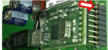
Öffnen der Frontabdeckung der Türstation und die Verbindung (Stecker auf der Platine siehe Abbildung) zum PC Programmiertool herstellen. Die LED auf dem Programmiertool blinkt ROT, sowie die gelbe LED auf der Platine der Türstation.
