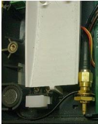
Kabel der Antenne durch die Öffnung auf der Rückseite der Türstation führen und an die interne Buchse anschrauben.
