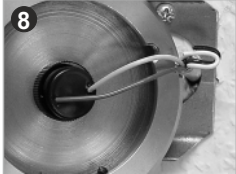
Dichtung auf Taster clippen Fixation of gasket on push
