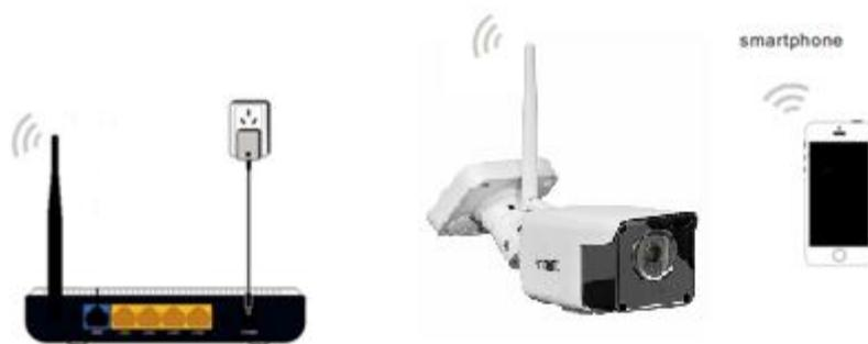
Öffnen Sie die WLAN-Einstellungen des Smartphones und wählen Sie die SSID der Kamera im AP-Modus (Access Point) aus. Die SSID ist vom Typ **URM\_** wie in der Abbildung unten dargestellt :
