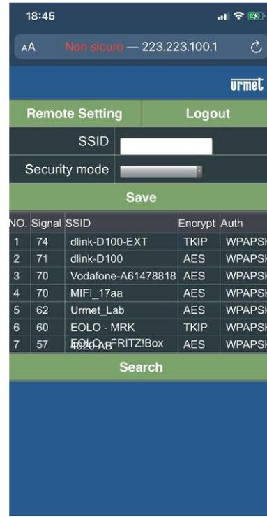
Wählen Sie das WLAN aus, das dem Internet-Router entspricht, an den Sie die Kamera anschließen möchten, und geben Sie das WLAN-Netzwerkennwort des Routers ein. Drücken Sie dann **Sichern** und warten Sie auf die Meldung **Gespeichert!** Niedriger:
