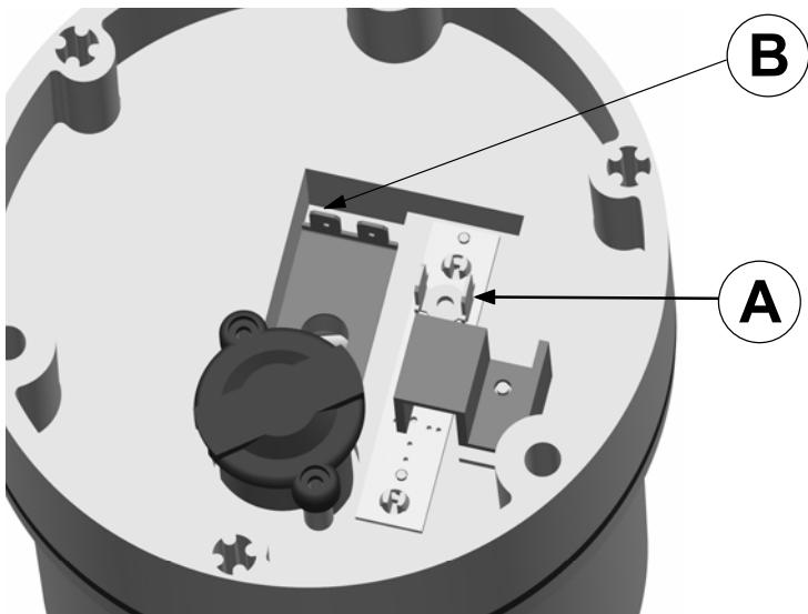
Das Produkt DSL 730X kann sowohl mit 12V= (DC) als auch mit 24V= (DC) versorgt werden. Der Anschluß erfolgt an den Klemmen A (+ Plus) und B (- Minus) unterhalb des Sockels. Auf richtige Polaritäten und korrekten Lampentyp (12V 55W oder 24V 70W) achten!
