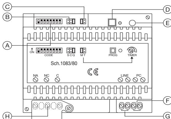
**A** – Dip-switch du code utilisateur pour l'identification du décodage dans le système
