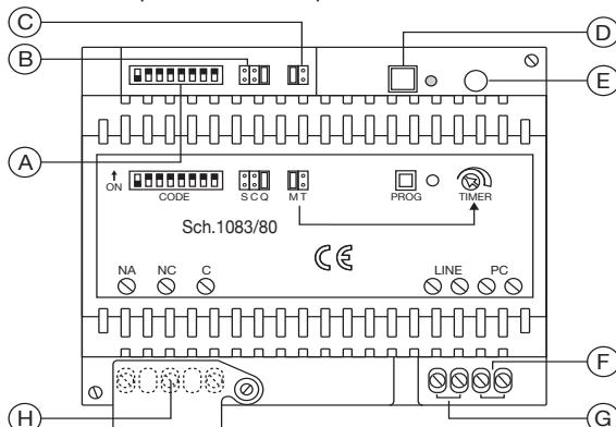
**A** - Dip-switch codice utente per identificazione della decodifica nell'impianto
