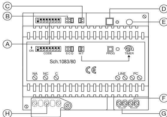
**A** – Dip-Schalter des Teilnehmercodes für die Erkennung des Decoders der Anlage
